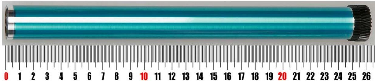
3. Покрытие на барабане прозрачное (свет отражается от алюминиевой поверхности барабана), это покрытие имеет при обычном освещении зеленые оттенки. Общая длина барабана 261 мм.
